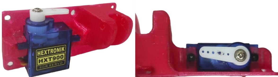
Рисунок – Установка сервопривода №34 в 3D печать №39.
