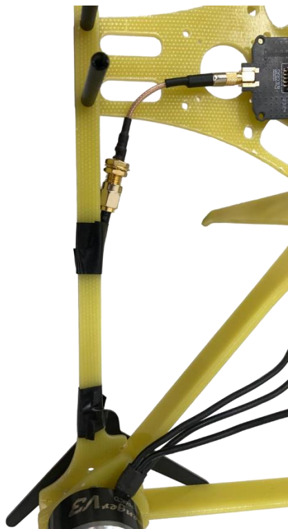
Рисунок – Крепление антенны №30 к раме.
