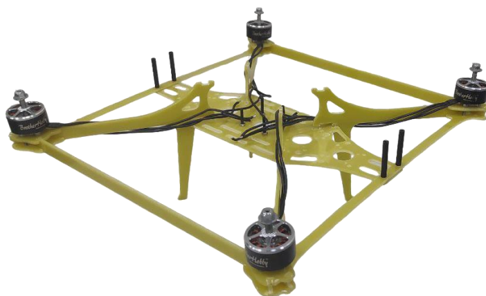
Рисунок ... - Результат фиксации всех моторов.
