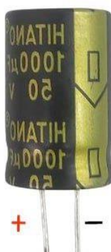
Рисунок – Полярность конденсатора №20.
