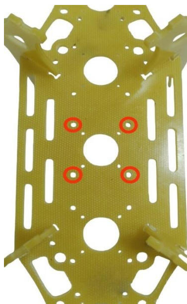
Рисунок – Технические отверстия для установки винтов №7.
