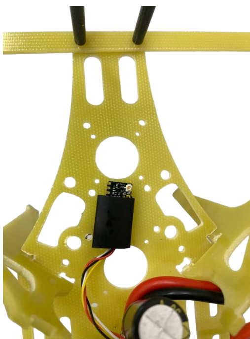
Рисунок – Установка термоусадочной трубки №26.
