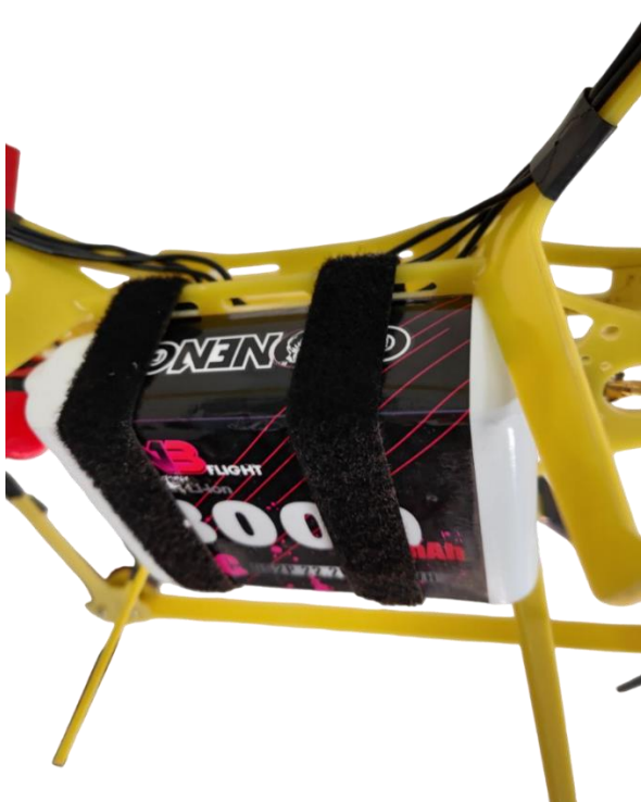
Рисунок – Установка и фиксация АКБ.
