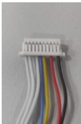
Рисунок ... - Правильно расположение проводов на шлейфе №23 для регулятора оборотов двигателя №13.
