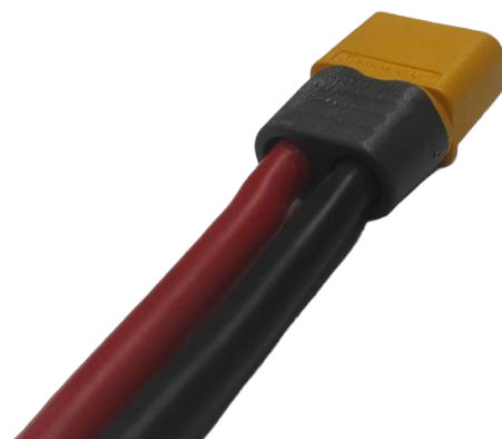
Рисунок – Изоляция контактов коннектора №18 защитной заглушкой №19.
