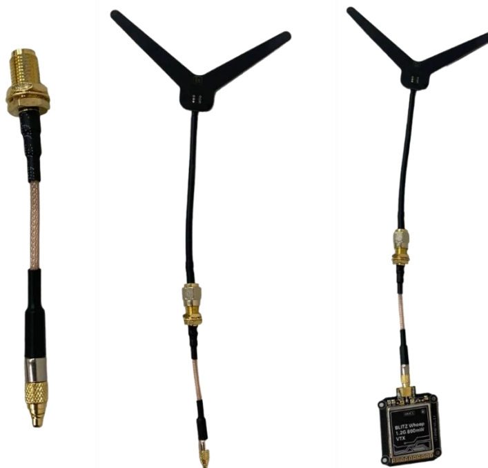
Рисунок – Установка переходника №31 к видеопередатчику №28 и антенне №30.
