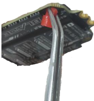
Рисунок ... - Установка демпферов №15 при помощи пинцета.
