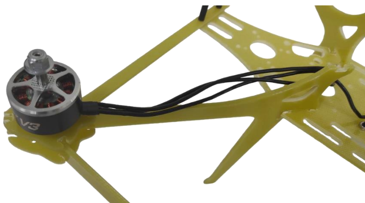
Рисунок ... - Расположение мотора №11 на луче.
