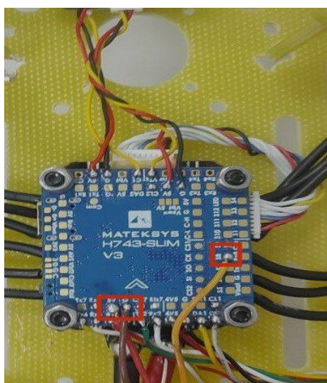
Рисунок - Подключение сервопривода №34 к ПК №21.
