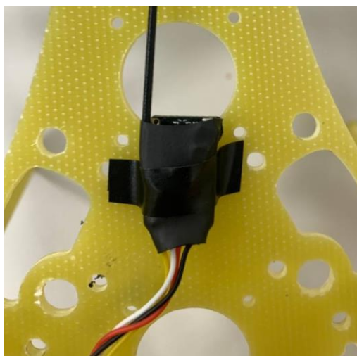
Рисунок – Итоговый результат фиксации приемника №24 на раме.
