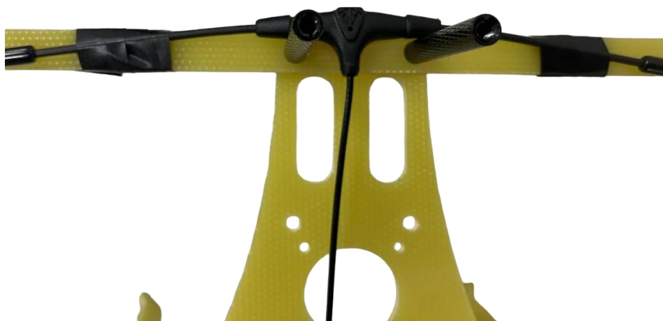
Рисунок – Правильное крепление антенны №27 при помощи изоленды.
