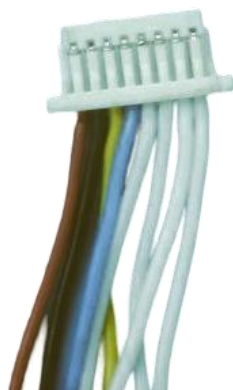
Рисунок ... - Правильно расположение проводов на шлейфе №23 для ПК №21.
