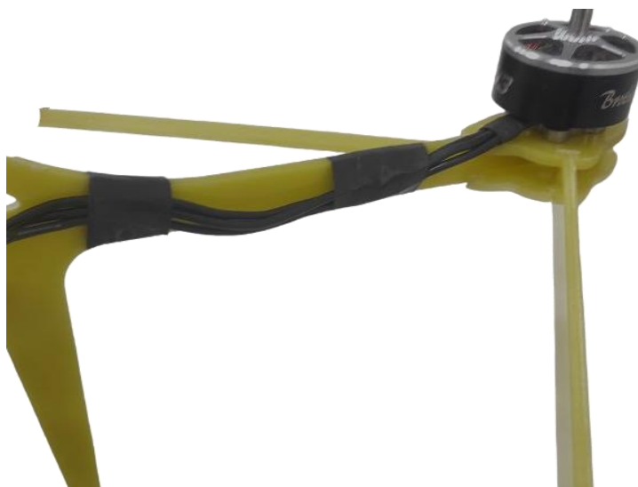
Рисунок – Фиксация проводов мотора при помощи изоленты.
