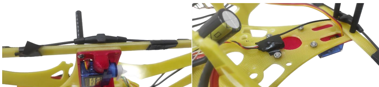
Рисунок – Установка 3D печати №39 к раме БПЛА.
