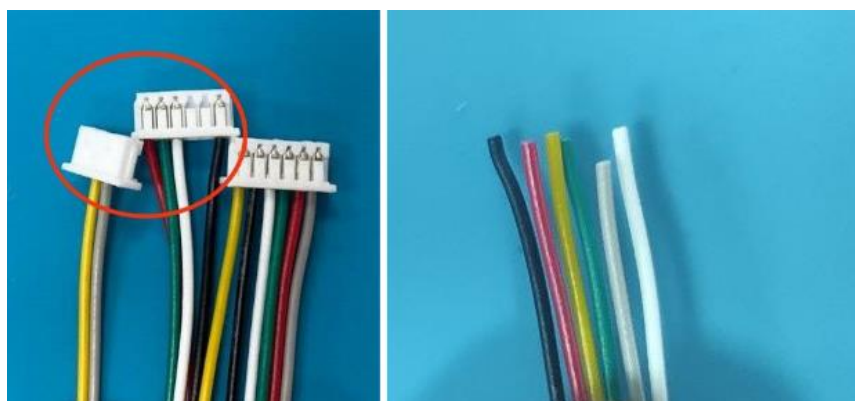
Рисунок – Два ненужных конекторов на шлейфе №43.
