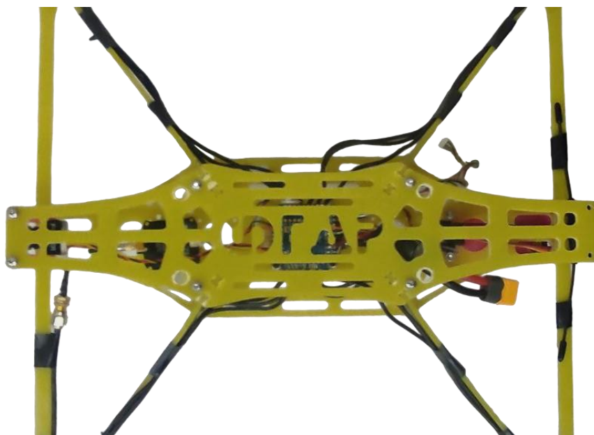
Рисунок – Конечный результат установки стоек №9 и верхней пластины №6.
